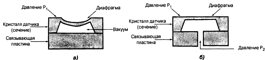
Рис. 10.32. Датчики абсолютного (а) и относительного (б) давления
