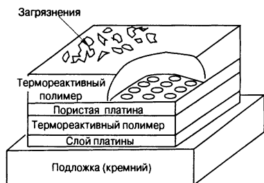
Рис. 10.40. Конструкция датчика относительной влажности NIN-3602
